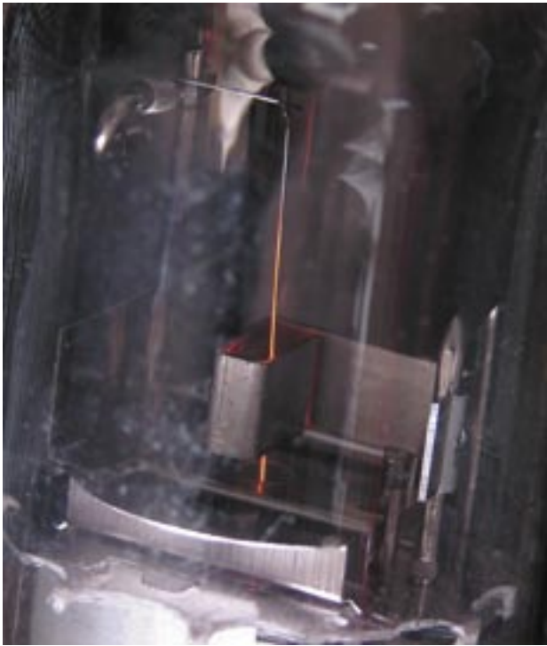
Röhren-Heizung in der Detailansicht
